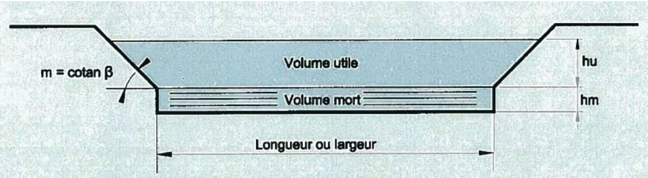
FIGURE 30 : COUPE TYPE D'UN BASSIN DE RETENTION (Source : Guide SETRA)
