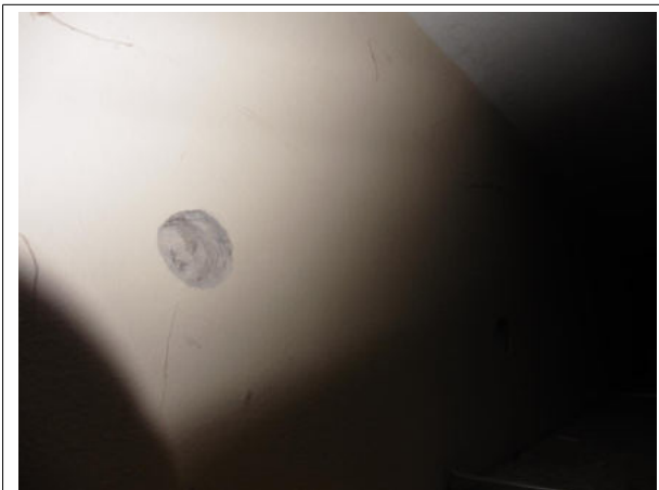
Prélèvement - P19 : RDC / 052 - Enduit- (Absence d'amiante)
