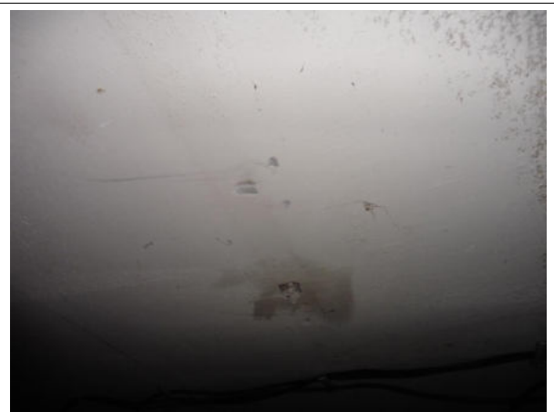
Prélèvement - P12 : RDC / 007 - Enduit- (Absence d'amiante)
