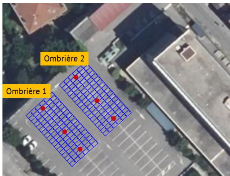
Figure 6 : Implantation prévisionnelle des fondations
