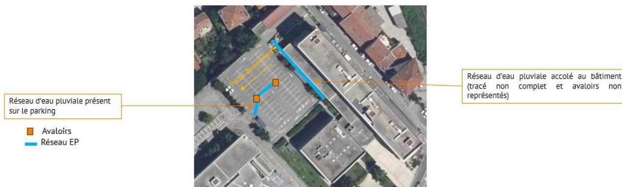
Figure 9 : Gestion des eaux pluviales actuelle sur le parking
