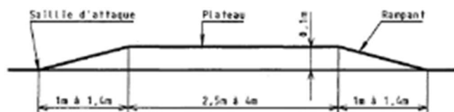
Profil en long ralentisseur « trapézoïdal »
