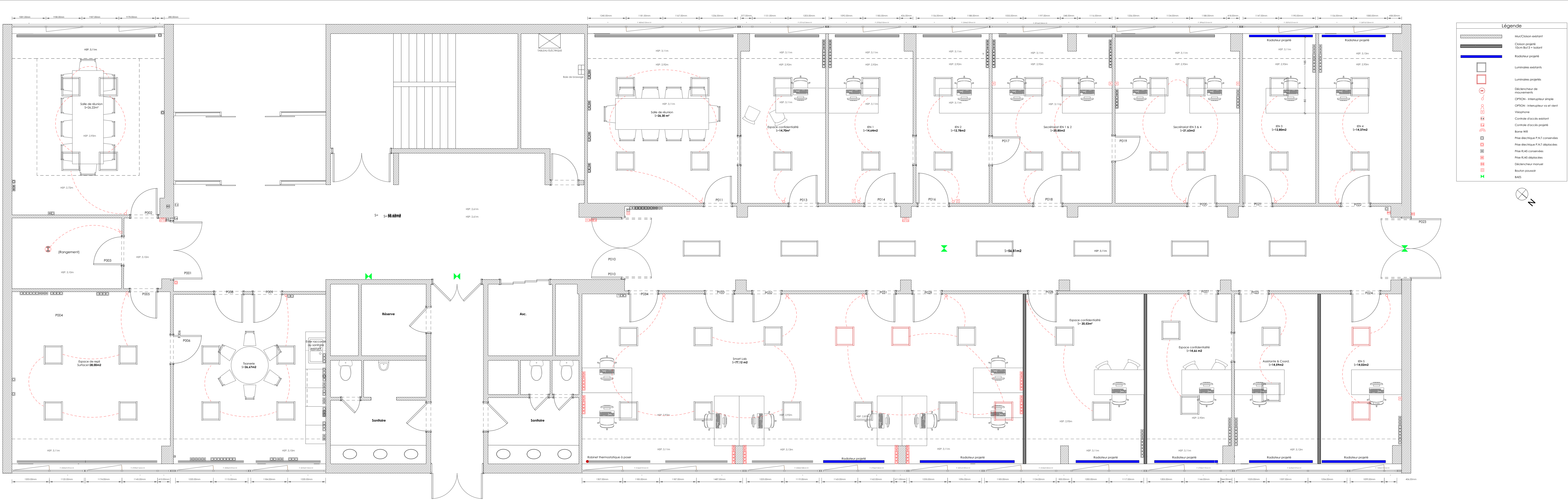
ETAT PROJETE Plan Cloisonnement et CFO/CFA 1/50
