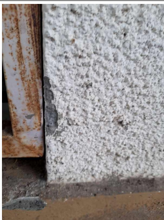
Prélèvement - P009 : Cour d'appel / Extérieur / Façade - Enduit - (Absence d'amiante)
