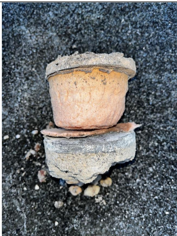
Photographie 4 : Complexe étanchéité + béton armé lessivé au carottage
