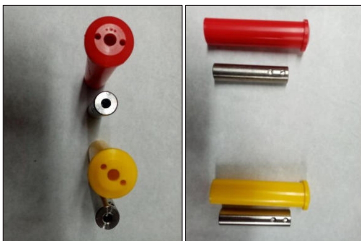
Figure 13 : Exemple de sonde de niveau avec électrode métallique et étui PEHD
