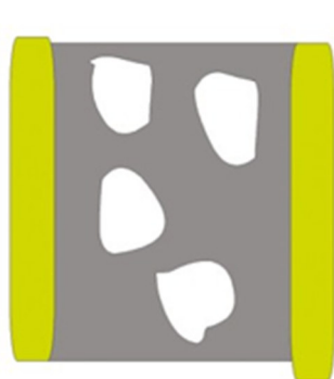
Reprise du tri-couche sur la largeur de la chaussée (virages notamment)
