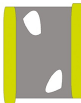
Reprise du tri-couche sur la largeur de la chaussée (virages notamment)
