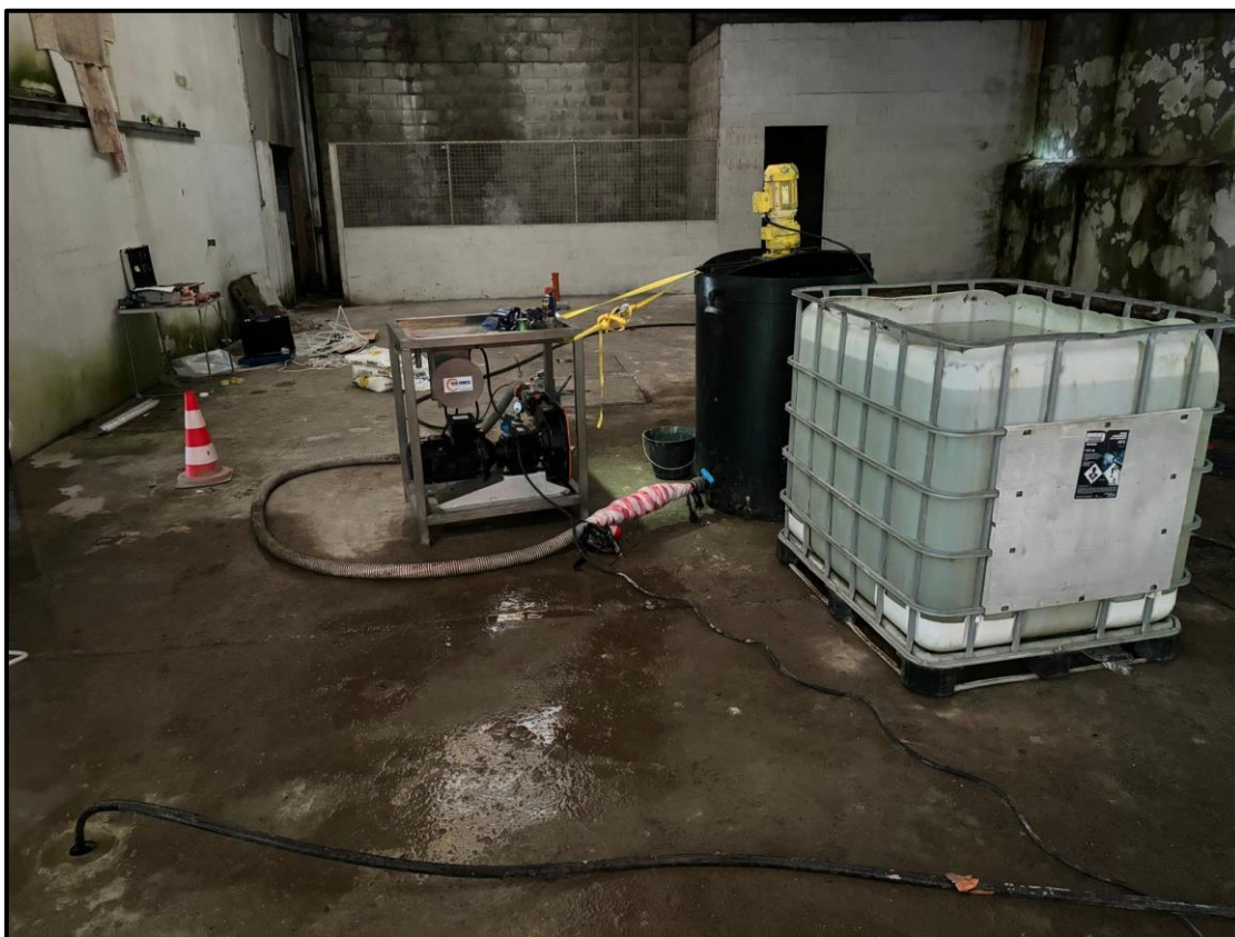
Figure 5 : Installation de l'essai pilote - injection en TAM (2)
