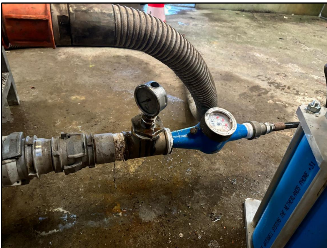
Figure 6 : Lecture en directe sur compteur volumétrique et manomètre
