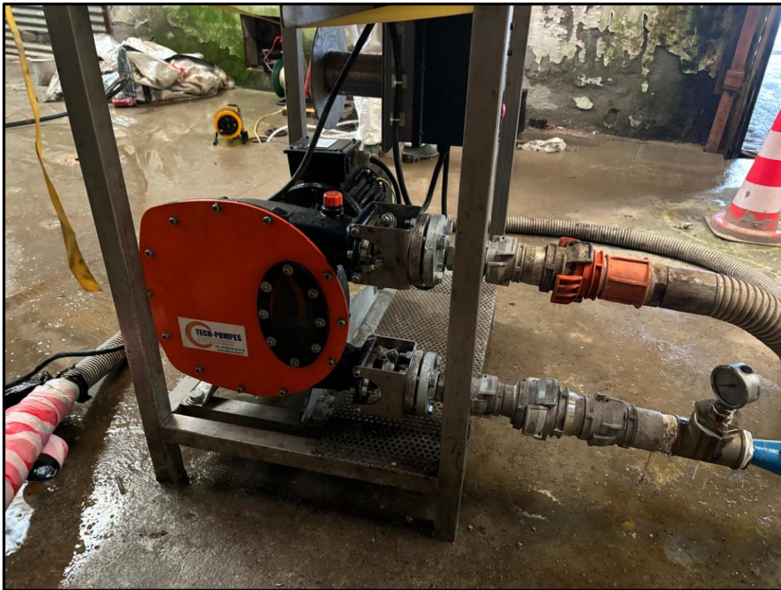
Figure 7 : Pompe d'injection de la solution (pompe péristaltique)
