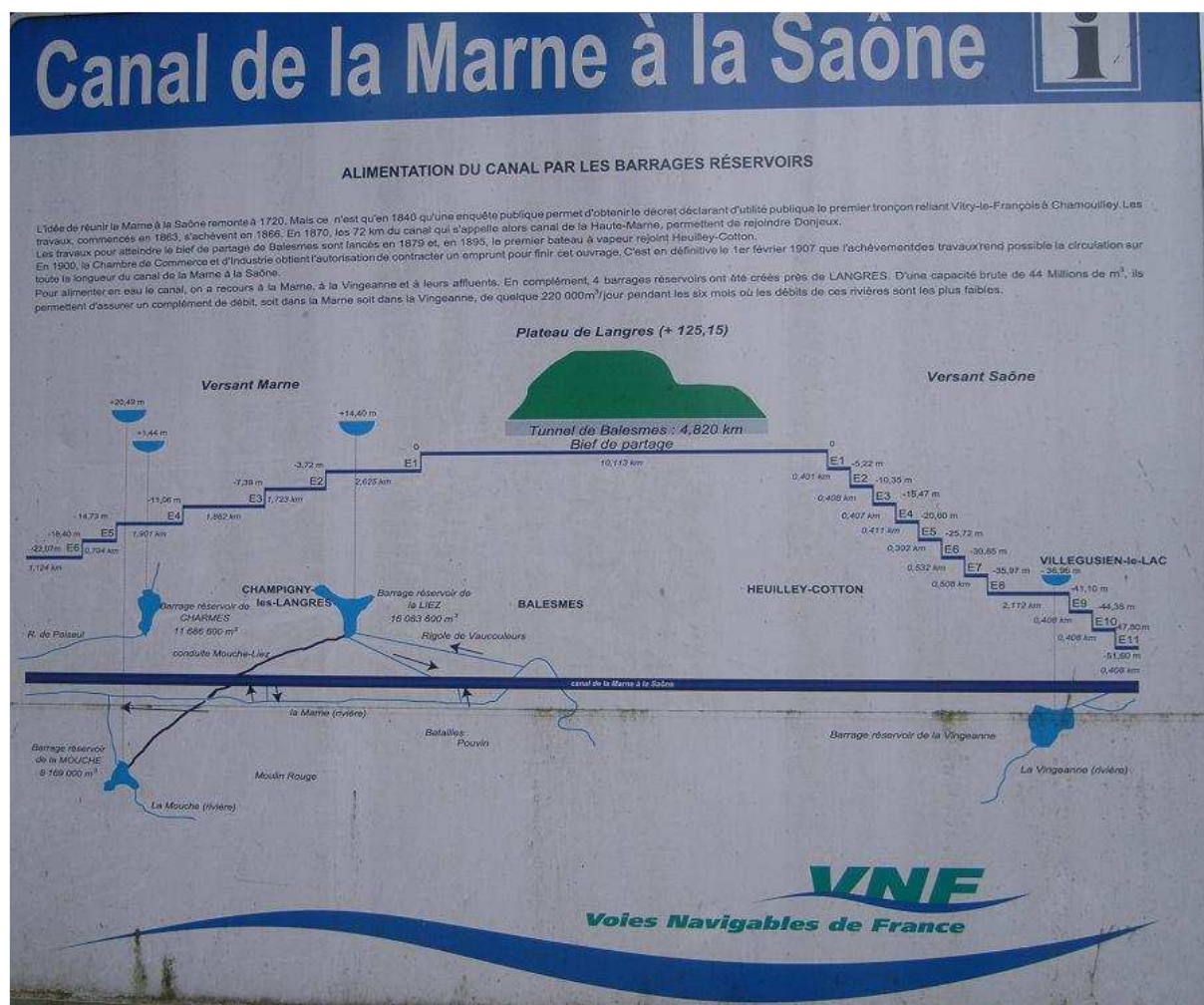
Réservoir de Charnes - Panneau expliquant le fonctionnement hydraulique de l'ensemble.
