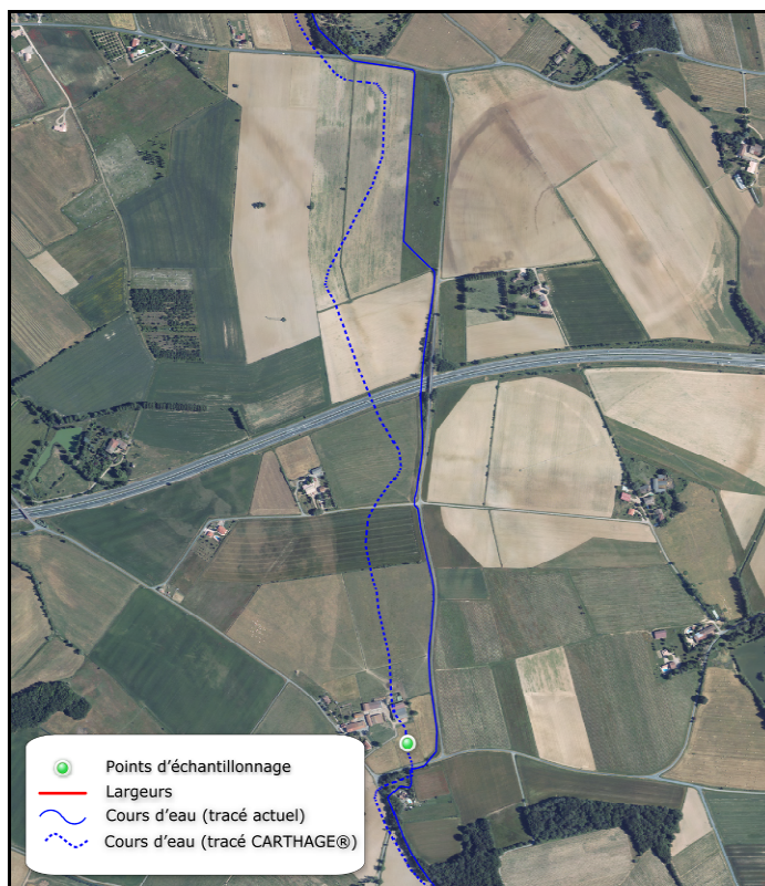
Figure 9 – Exemple de rectification du cours d'eau en zone agricole.
