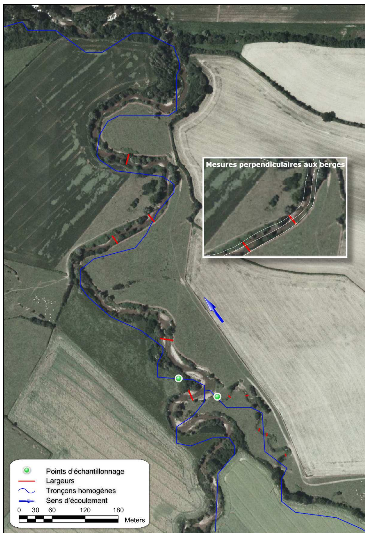
Figure 3 - Exemple d'échantillonnage et de mesure des largeurs à pleins bords
