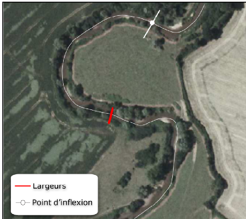
Figure 6 - Méandre, point d'inflexion et mesure de la largeur pleins bords
