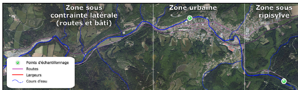
Figure 8 – Tronçon artificiel à plus de 50 % de son linéaire : les largeurs ne sont pas mesurées mais le tronçon est renseigné comme artificiel.
