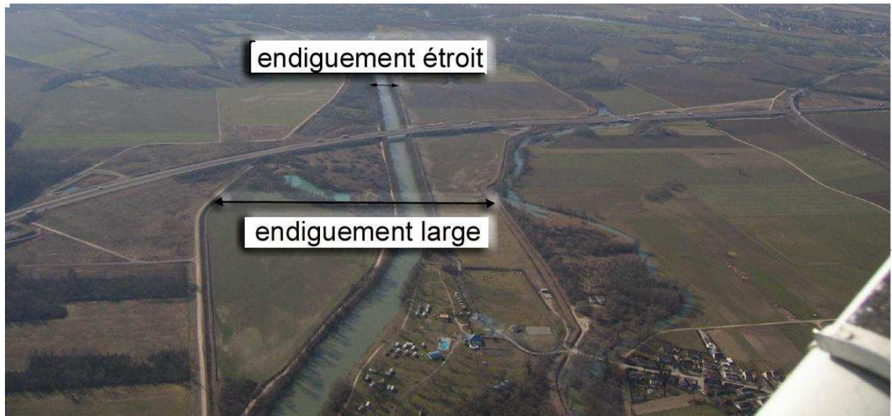
Figure 12 : Vue aérienne d'un système à double endiguement : étroit pour les crues fréquentes et large pour les crues plus rares (photo JR Malavoi)
