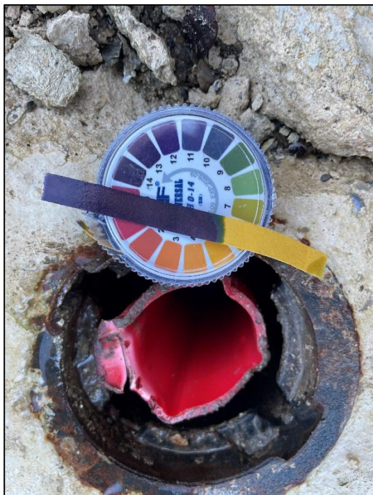
Mesure du pH manuelle avec papier Ph dans SCA1 (gauche) et au droit d'une résurgence (droite) – 25/01/2024 - Géolithe
