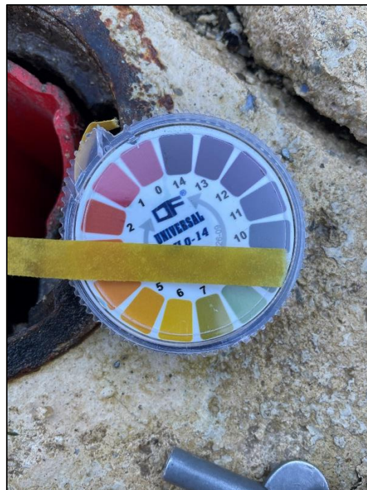
Mesure du pH manuelle avec papier Ph dans SCA1 (gauche) et au droit d'une résurgence (droite) – 25/01/2024 - Géolithe
