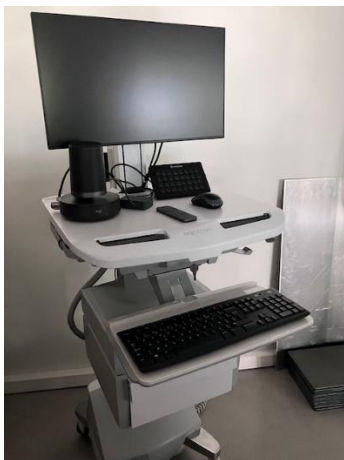
Robot mobile pour présentation showroom en distanciel caméra, écran, audio, streamdeck, liaison Wifi
