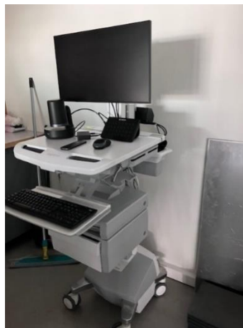
Robot mobile pour présentation showroom en distanciel caméra, écran, audio, streamdeck, liaison Wifi
