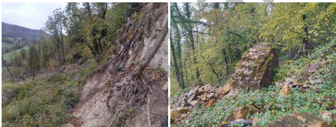
A gauche : cicatrice en pied de paroi côté Sud, avec racines d'arbres à nu A droite : strate rocheuse éboulée, V \sim 5.4 \text{ m}^3
