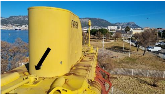
Figure 13 : Localisation de l'anneau de levage à l'avant de la baignoire
