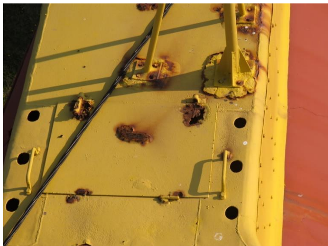
Figure 165 : Vue générale de verrous sur le pont supérieur arrière en 2007 (gauche) et 2018 (droite)
