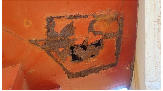
Figure 33 : sous-face de la carène, côté proue : perforation quasi-totale de réparations de tôles
