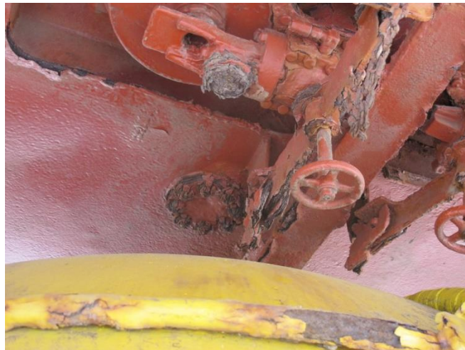
Figure 97 : Dessous de carène, au-dessus de la sphère, détail corrosion en 2007 (gauche) et 2018 (droite)
