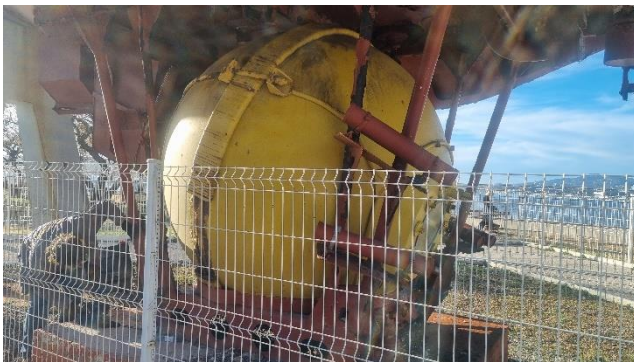
Figure 36 : Vue générale de la sphère, 3/4 bâbord arrière, présence des agrafes d'assemblage des 2 demi-sphères
