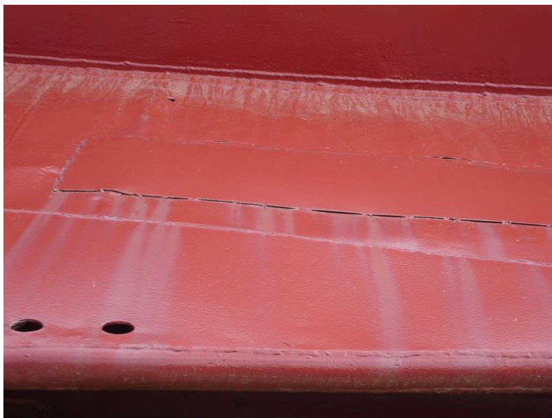
Figure 129 : Détail du stabilisateur tribord et sa réparation par soudure en 2007
