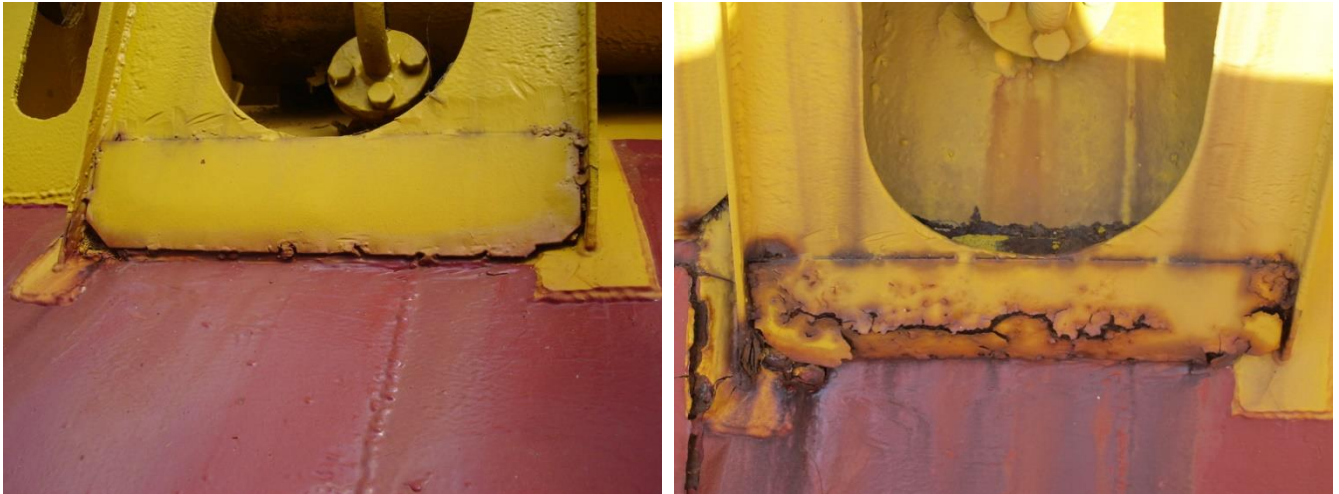
Figure 151 : Détail de la partie inférieure du bloc-hélice bâbord en 2007 (gauche) et 2018 (droite)
