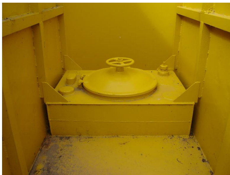
Figure 181 : Vue de l'intérieur de la baignoire, écoutille d'entrée dans le bathyscaphe en 2007
