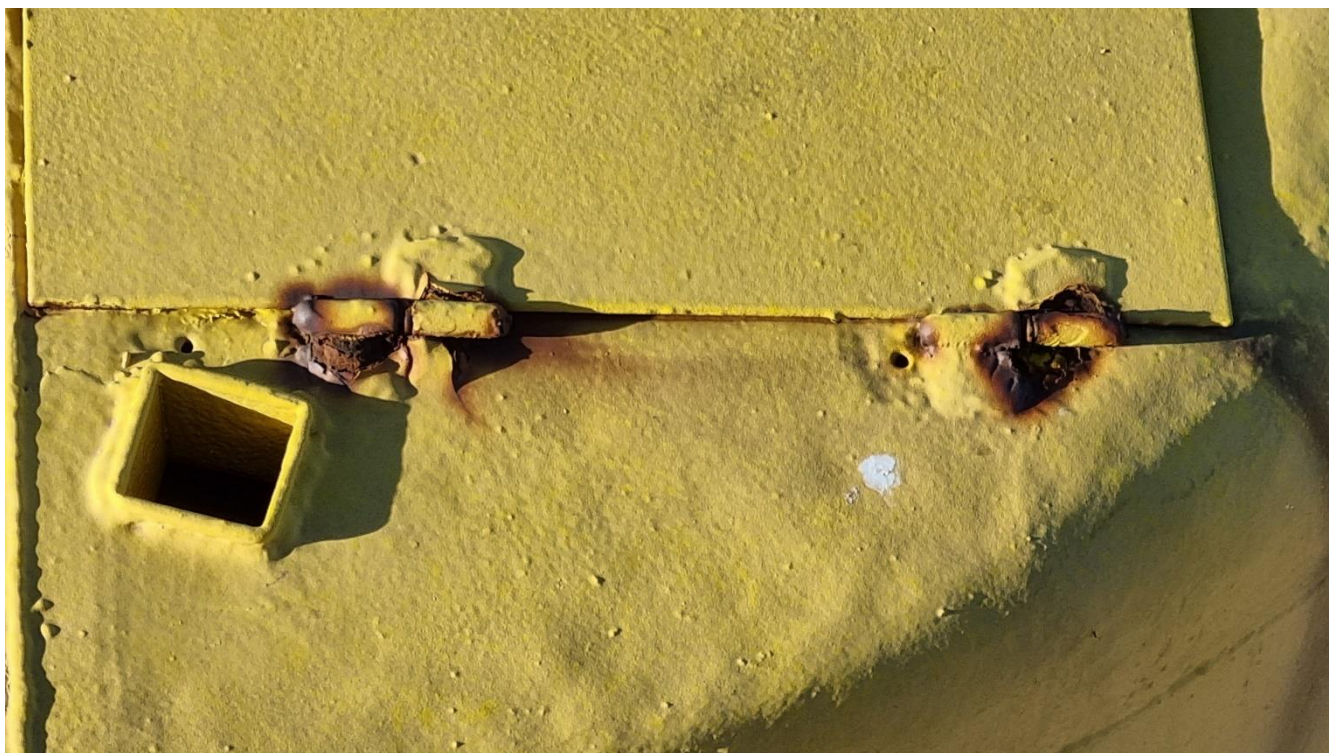
Figure 168 : Détail de cette même charnière sur le pont supérieur arrière en 2025
