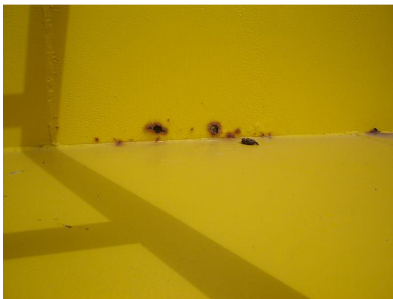
Figure 183 : Perforations côté bâbord, en fond de baignoire, vues de l'extérieur (2007)
