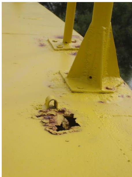
Figure 173 : Détail d'un verrou disparu sur le pont supérieur arrière avec perforation de la coque (2007)
