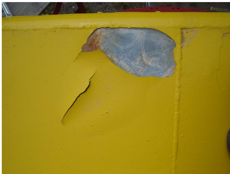
Figure 177 : Vue générale d'un écaillage de peinture sur le pont supérieur arrière (2007)
