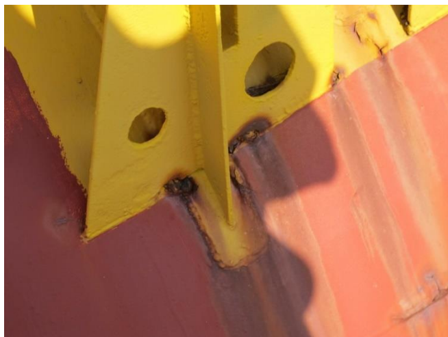
Figure 153 : Détail de l'intérieur du bloc-hélice bâbord, zone de rétention d'eau, corrosion (2007 – 2018)
