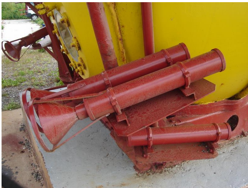
Figure 109 : Détail des projecteurs tribord en 2007 (tubes PVC)
