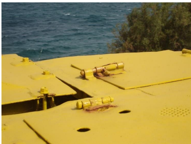
Figure 165 : Vue générale de verrous sur le pont supérieur arrière en 2007 (gauche) et 2018 (droite)
