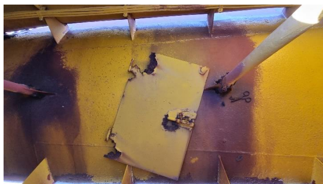
Figure 23 : trappe avant reposant sur la coque du sous-marin
