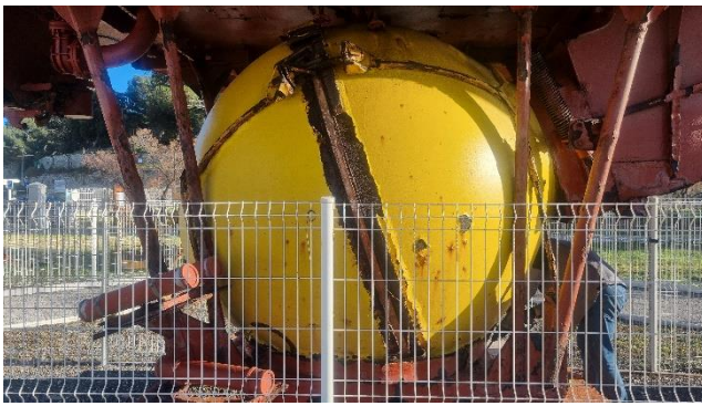
Figure 34 : vue générale de la sphère, côté tribord, disparition de toutes les agrafes d'assemblage de la demi-sphère
