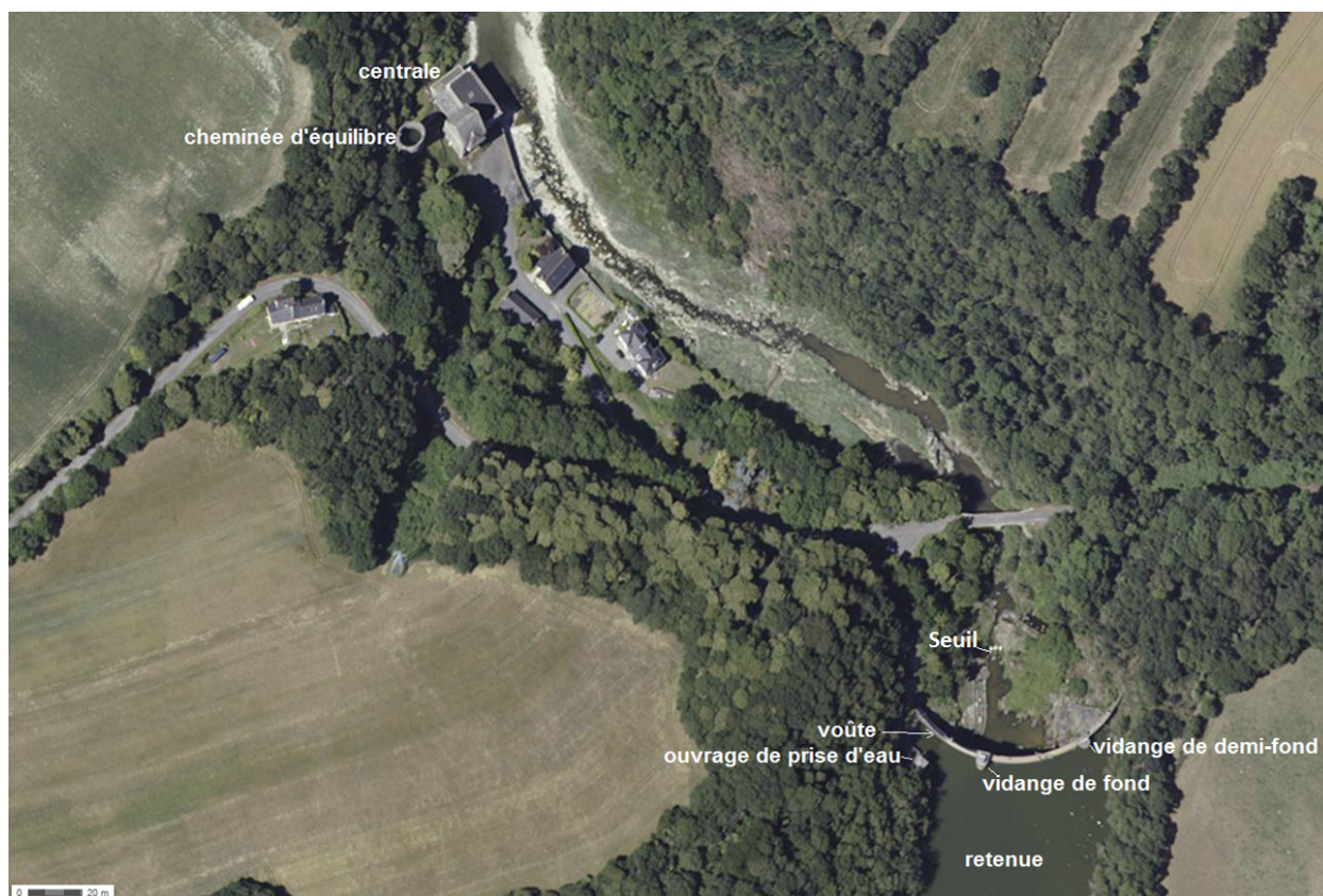
Figure 2.1 Vue aérienne du barrage de Pont Rolland et des différents ouvrages et organes visibles
