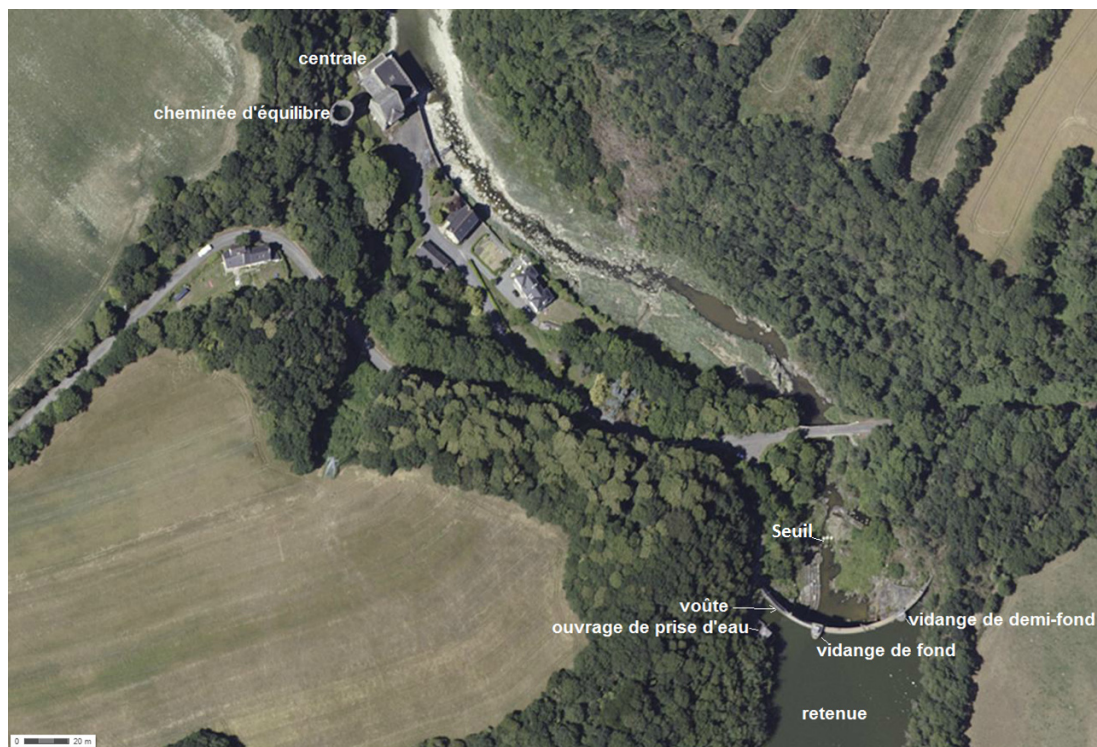
Figure 0.2 Vue aérienne du barrage de Pont Rolland et des différents ouvrages et organes visibles
