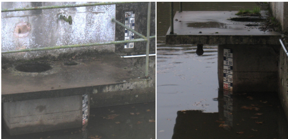
Figure 3.31 Echelle limnimétrique
