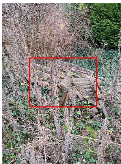
Extérieur: Dépôt au sol de tôles amiante ciment
