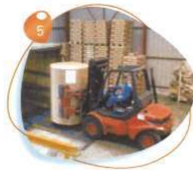
Utilisation d'un chariot automateur à conducteur porté pour décharger des bobines de papier
