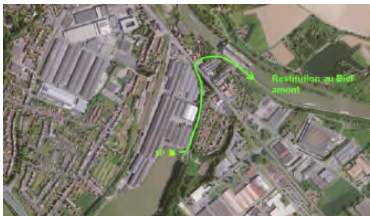
Figure 5 : Cheminement de la conduite de refoulement envisagée diam. 1400mm dans la galerie de l'évacuateur
