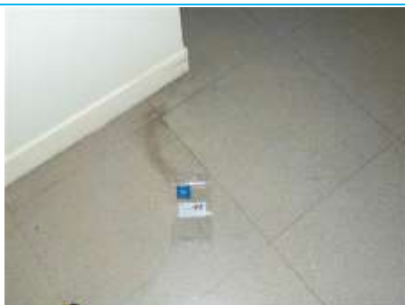
Matériaux : ZPSO-011 Prélèvement : P011 Description : Lé plastique Localisation : Sous-Sol - Dosimètre, Atelier caches Résultat : Absence d'amiante
