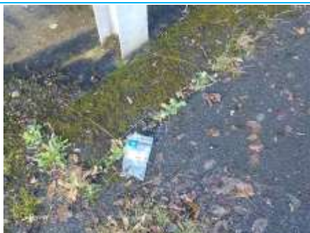
Matériaux : ZPSO-019 Prélèvement : P019 Description : Enrobé bitumineux Localisation : Parties extérieures Résultat : Absence d'amiante
