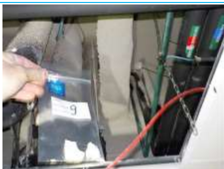
Matériaux : ZPSO-009 Prélèvement : P009 Description : Flocage Localisation : Sous-Sol - Sous-sol Résultat : Absence d'amiante
