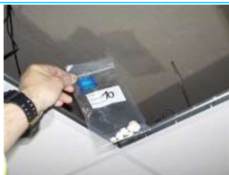
Matériaux : ZPSO-010 Prélèvement : P010 Description : Flocage Localisation : Sous-Sol - Sous-sol Résultat : Absence d'amiante
