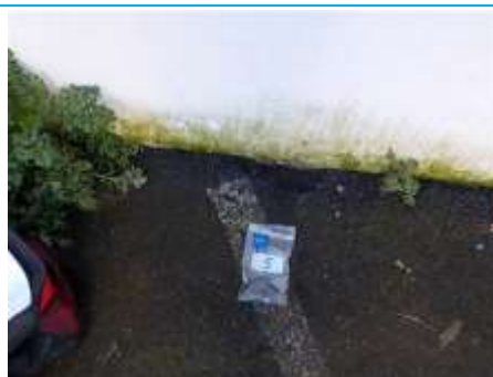
Matériaux : ZPSO-022 Prélèvement : P022 Description : Enrobé bitumineux Localisation : Parties extérieures Résultat : Absence d'amiante
