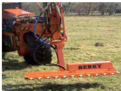
Illustration 16 : Barre de coupe avec andaineuse Berky
