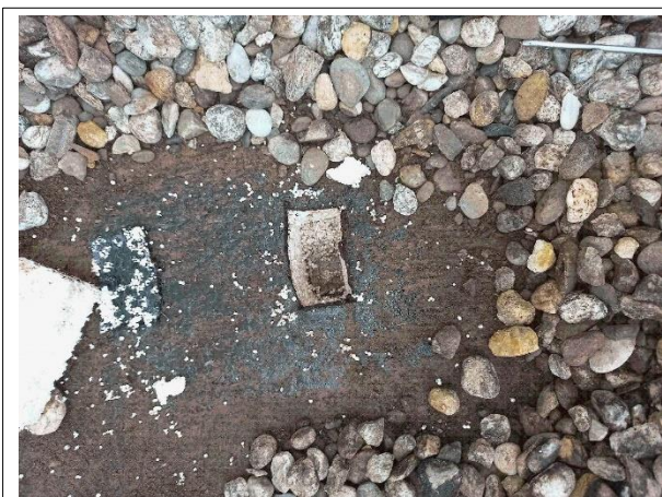
Prélèvement - P007 : TOITURE 1 - Revêtement bitumineux- (Absence d'amiante)
