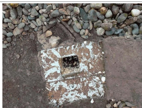
Prélèvement - P008 : TOITURE 1 - Revêtement bitumineux- (Absence d'amiante)
