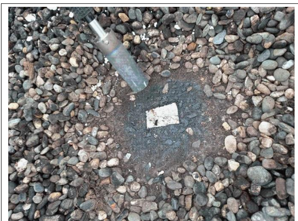
Prélèvement - P015 : TOITURE 3 - Revêtement bitumineux- (Absence d'amiante)
