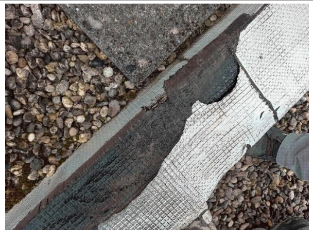
Prélèvement - P004 : TOITURE 2 - Bardeau bitumineux- (Absence d'amiante)
