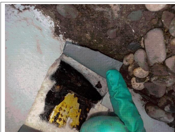
Prélèvement - P011 : TOITURE 1 - Bardeau bitumineux- (Absence d'amiante)
