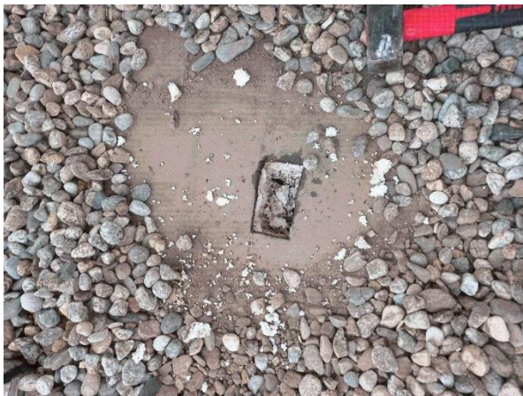
Prélèvement - P001 : TOITURE 1 - Revêtement bitumineux- (Absence d'amiante)
