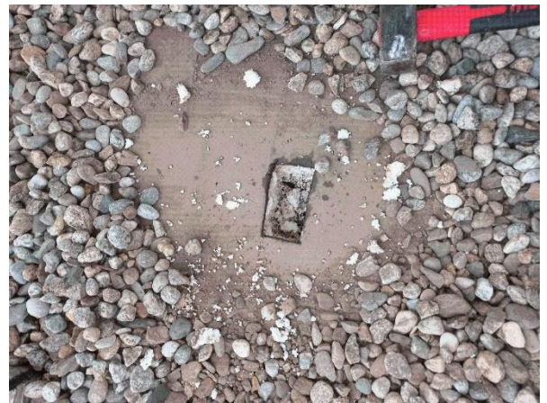
Prélèvement - P002 : TOITURE 1 - Revêtement bitumineux- (Absence d'amiante)
