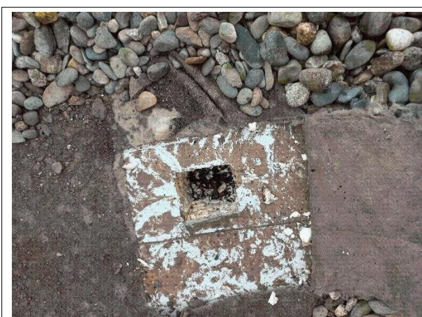
Prélèvement - P009 : TOITURE 1 - Revêtement d'étanchéité- (Absence d'amiante)
