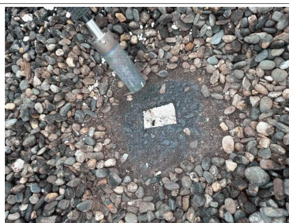
Prélèvement - P014 : TOITURE 3 - Revêtement bitumineux- (Absence d'amiante)
