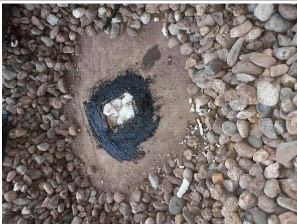
Prélèvement - P003 : TOITURE 1 - Revêtement bitumineux- (Absence d'amiante)
