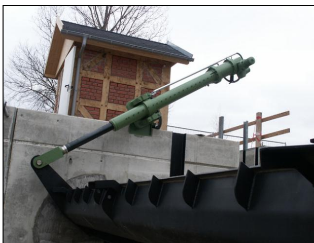
Fig. 38. Exemple de vérins électromécaniques
