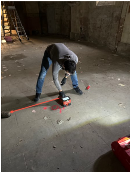
C6: sondage au pachometre PS300 et radar PS1000
