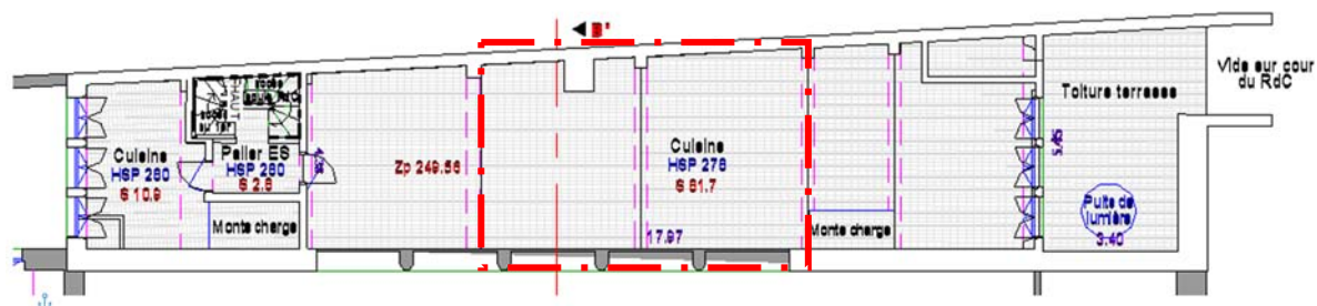
Vue en plan générale : localisation des poutrelles impactées par les désordres
