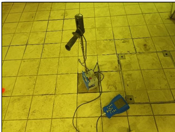
2/7/2024 : Essai au pénétrömètre portatif P4
