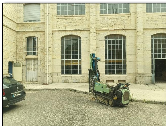
2/7/2024 : Essai au pénétromètre dynamique PD7
