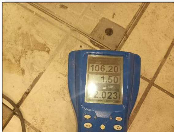
2/7/2024 : Essai au pénétrömètre portatif P4
