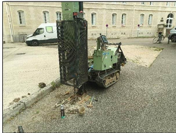
Figure 1 - Essai au pénétromètre dynamique lourd de type B – 2/7/2024
