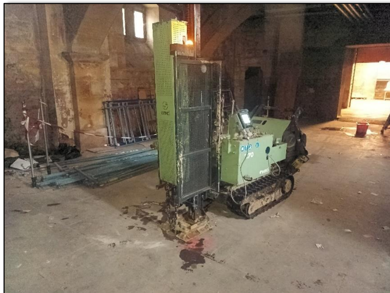
2/7/2024 : Essai au pénétromètre dynamique PD6
