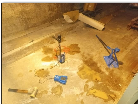
2/7/2024 : Essai au pénétromètre portatif P3
