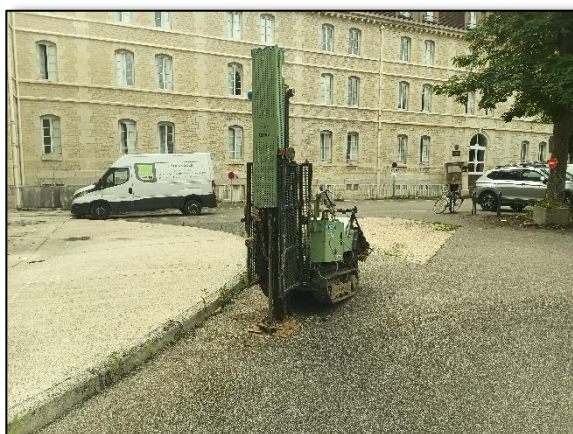
2/7/2024 : Essai au pénétromètre dynamique PD7
