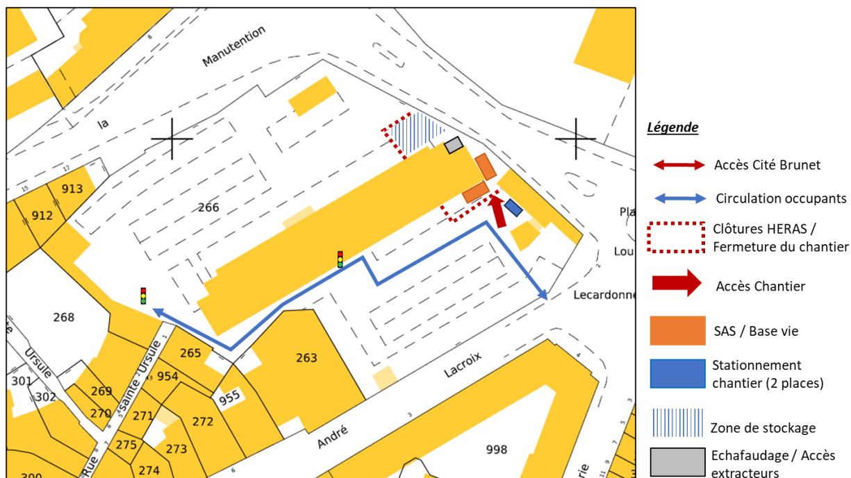
Figure 5. Plan d'installation prévisionnelle de chantier - Cage NORD
