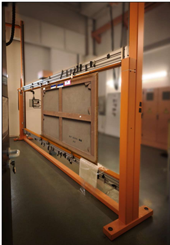
Figure 1 Radiographie sur un tableau en toile avec châssis bois, maintenu par le chevalet utilisé sur le site C2RMF de Paris depuis 1999.
