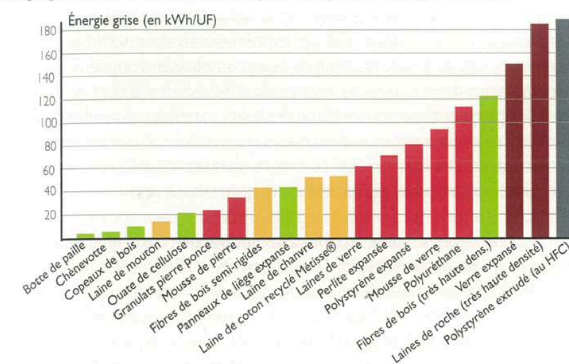
Coût « Énergie grise » de 1 m 2 de divers isolants pour une épaisseur correspondant à une résistance thermique de 5 m 2 K/W.
