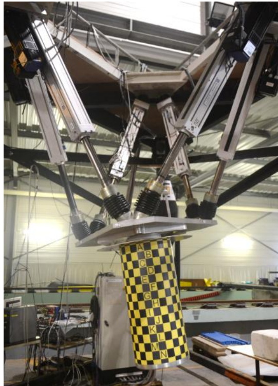
Figure 8 : Mesure des propriétés mécaniques des dispositifs d'essais : position du centre de gravité et moments d'inertie
