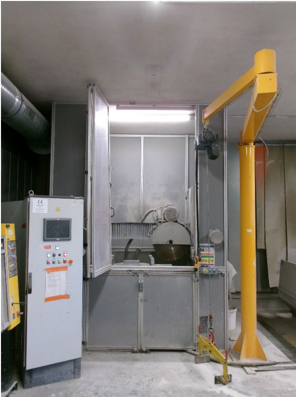
Figure 1 : photo du banc de sciage automatique avec l'armoire de commande
