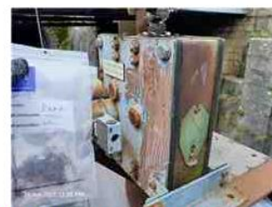
Boîtier fermeture vantelle Peintures bleue + rouge 3,2 mg / cm²
