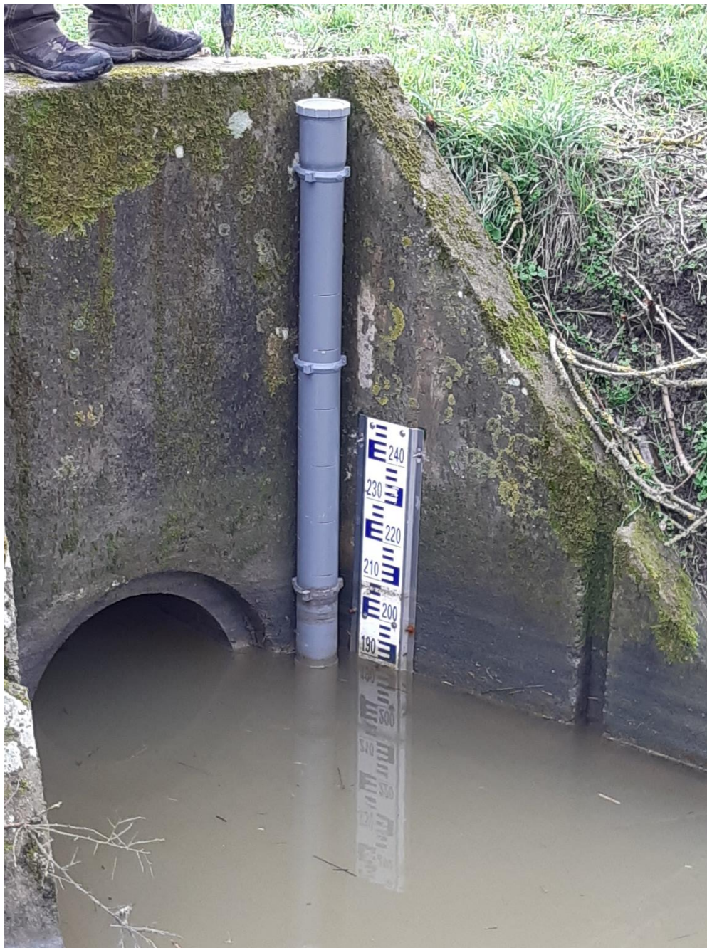
Figure 12 : Photographie d'une échelle limnimétrique et d'un support de sonde (diamètre 100 mm en pvc), Sonde télétransmise N°6 (charron)
