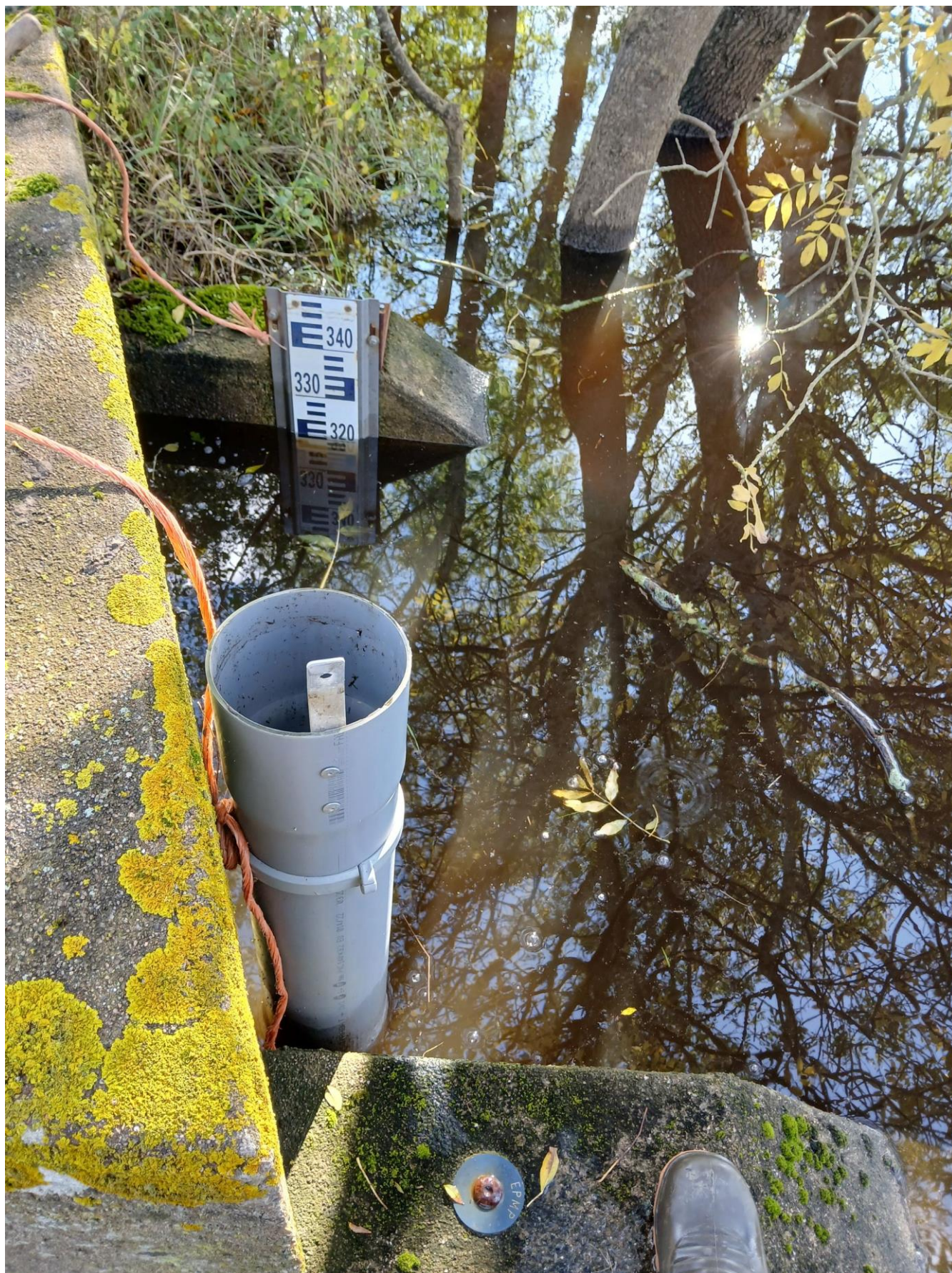
Figure 6 : Photographie avec un clou siglé EPMP, une échelle limnimétrique et un support de sonde.
