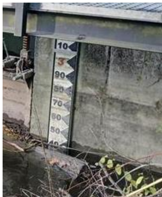
Figure 10 : Échelle mal graduée (tous les 5 cm et cote absolue illisible au-dessus de 3 m NGF).
