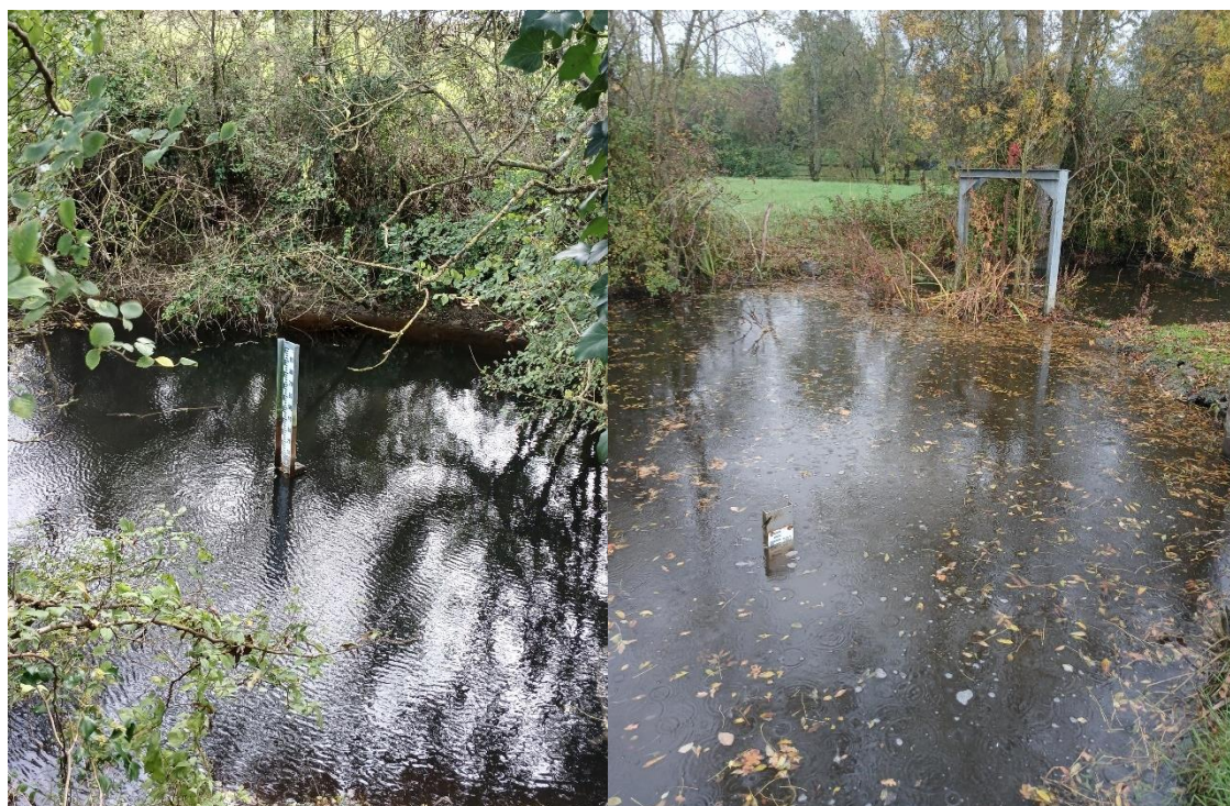
Figure 18 : exemples d'échelles inaccessibles depuis les berges en hiver.
