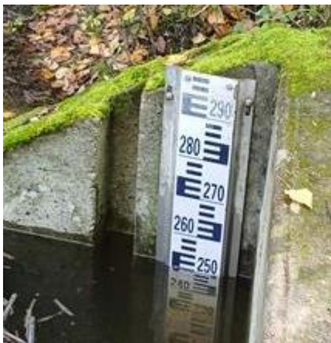
Figure 9 : Échelle correctement graduée en centimètres NGF.
