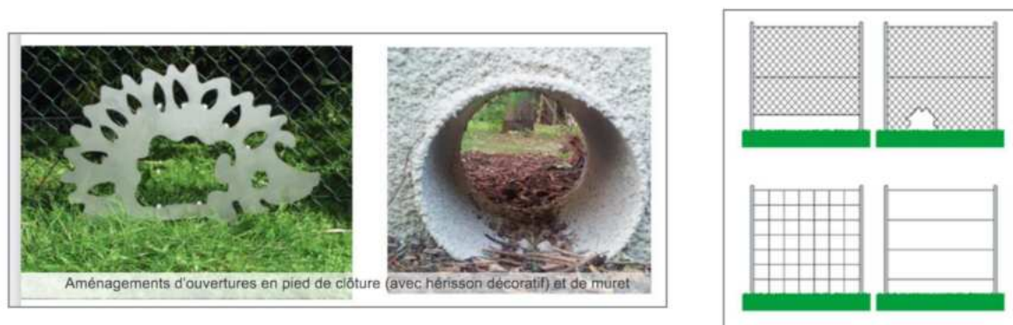
Figure 12. Ouverture de passages sur clôtures et murets -à gauche- et types de grillage adaptés à la circulation de la petite et moyenne faune -à droite- (Sources : urbanisme-bati-biodiversite.fr et 1001sitesnatureenville.ch )
