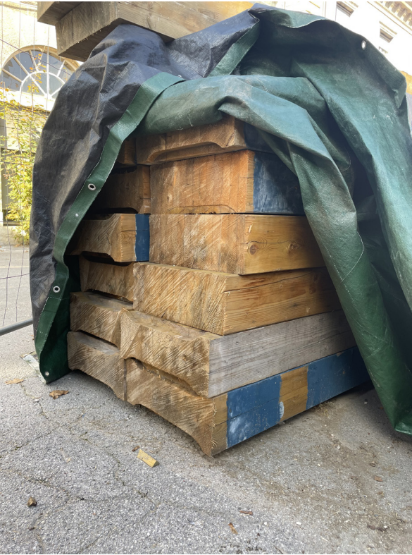
Bois lamellé collé Pin Rabotage à prévoir issu de la dépose des charpentes existantes
