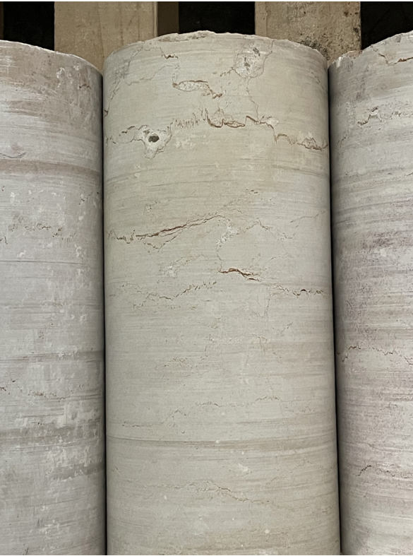
Carottage de pierre Pierre de ? issu du chantier - pierre de façade Dimensions : ø 160mm hauteur variable env.450mm
