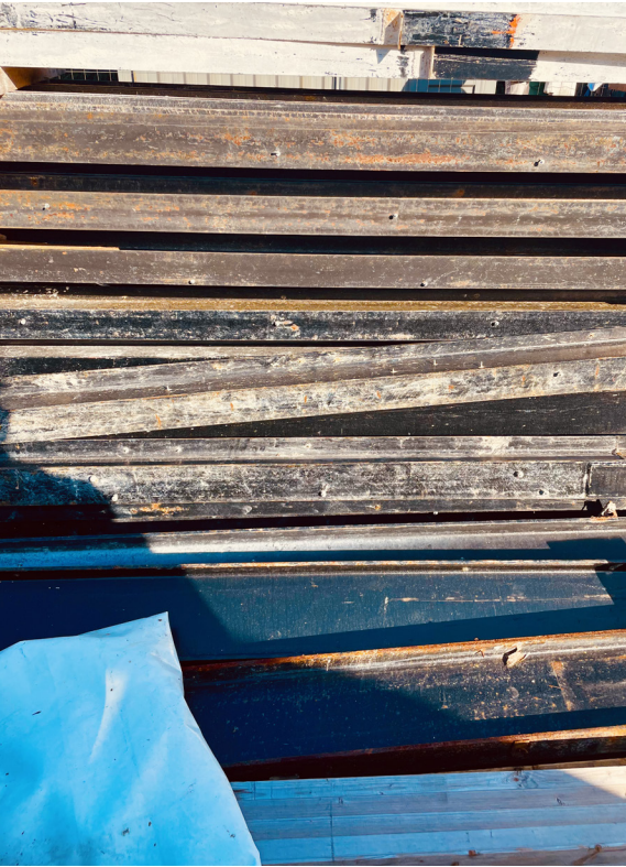
Poutrelles métalliques Acier brut issu de la dépose des charpentes existantes
