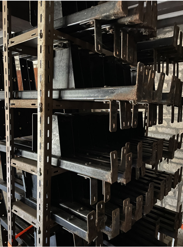
Piètement de sieges rabattables Acier laqué noir issu de la dépose des assises de l'amphithéâtre
