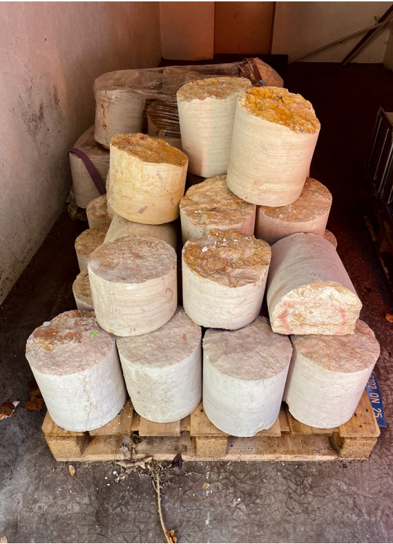
Carottage de pierre Pierre de ? issu du chantier - pierre de façade Dimensions : ø 250mm hauteur variable env.450mm
