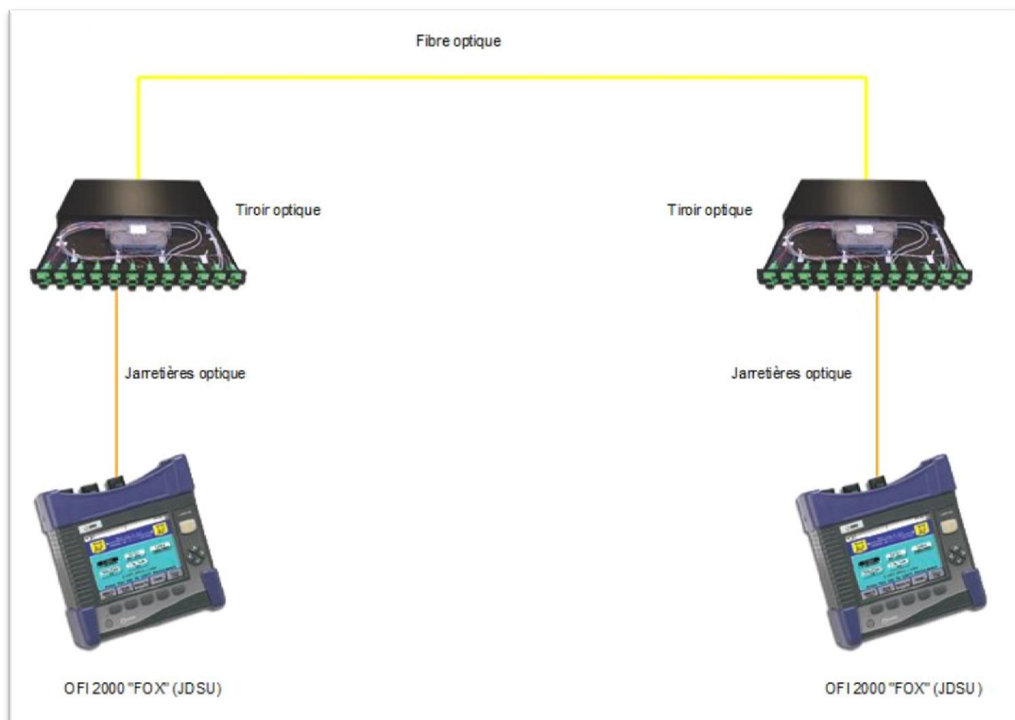
Schéma de principe d'une mesure d'insertion
