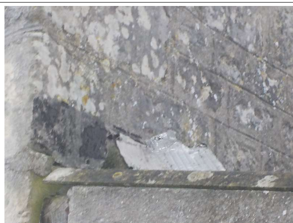
Prélèvement - P4 : Cabanon - Revêtement d'étanchéité- (Absence d'amiante)
