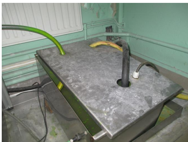
Doc DG-6 - Stockage des eaux de rinçage
