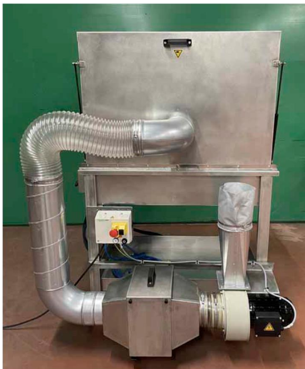
Doc ST VI-1 - Poste de ressuage autonome avec aspiration/filtration Les 2 carters anti-éclaboussure ne figurent pas sur les photos
