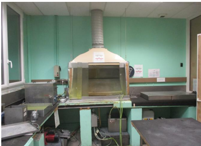
Doc ST III -6 : Bac de lavage sous UV du local 055
