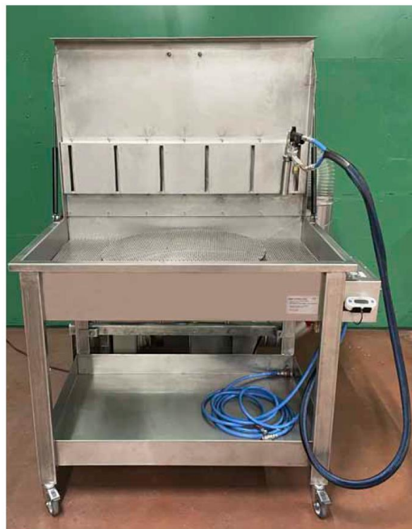
Doc ST VI-1 - Poste de ressuage autonome avec aspiration/filtration Les 2 carters anti-éclaboussure ne figurent pas sur les photos
