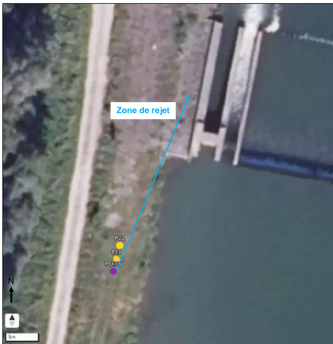
Plan d'implantation du dispositif de l'essai de pompage (puits et piézomètres (PZ))
