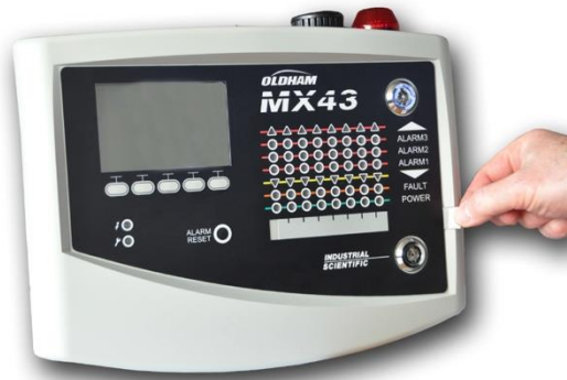
Figure 13 : extraction de la languette.
