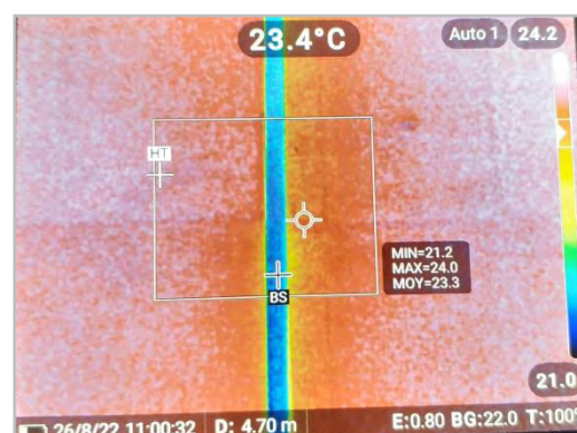
Figure 6 : Pont thermique au droit du joint.
