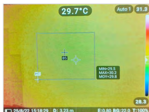
Figure 4 : Isolation cloison intérieur
