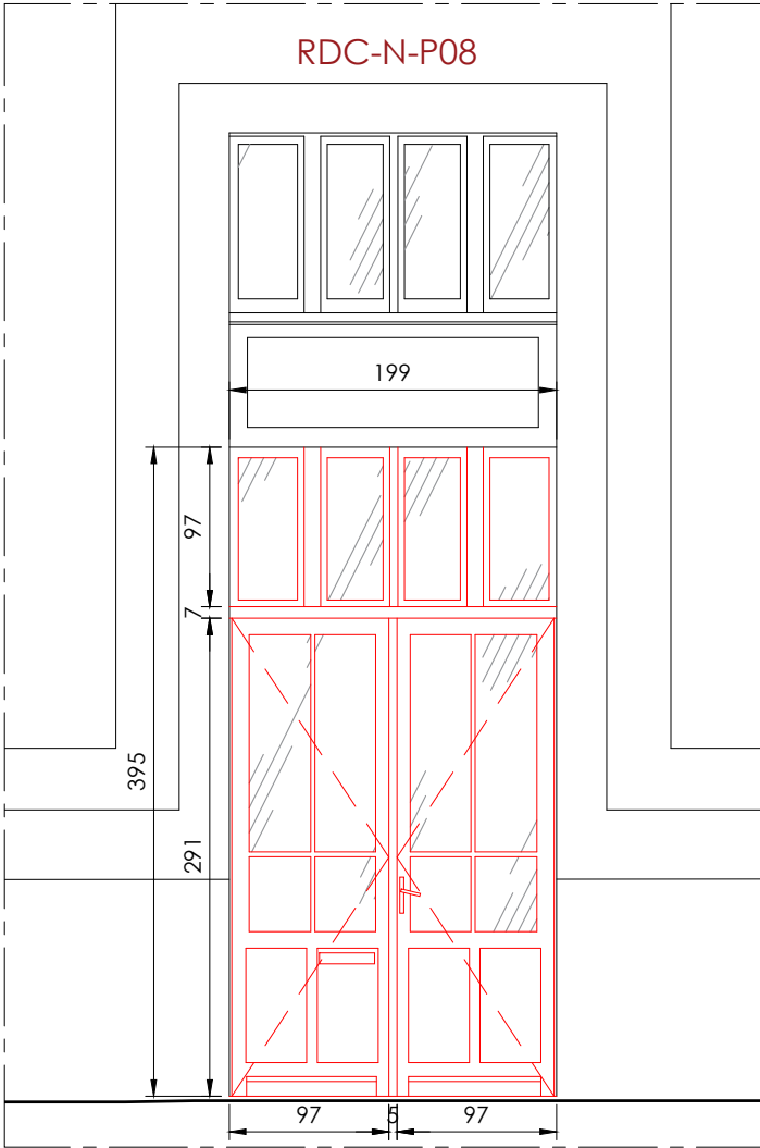
Coupe détail sur la porte - Échelle 1:50
