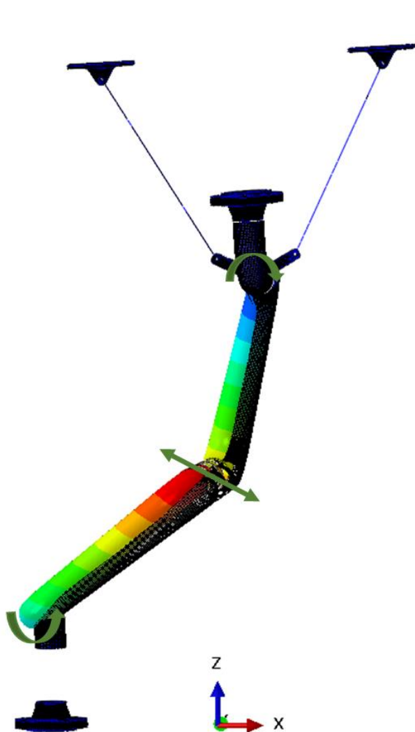
Figure 15 : Déformée modale F1 = 4Hz
