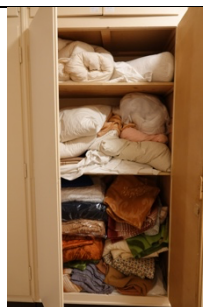
Supprimer tout stockage de matières facilement inflammables dans les circulations (couverture, draps...) et transférer ces matériaux dans un local de stockage adapté, conforme aux prescriptions de sécurité incendie.
