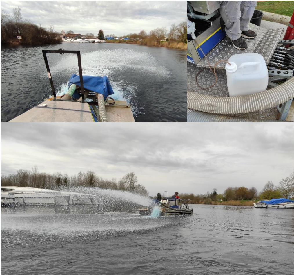
Figure 15 : Prise de vue n° : Application des biotraitements le 29/03/2023 grâce à l'engin amphibie et sa buse d'épandage. Crédit Inoval
