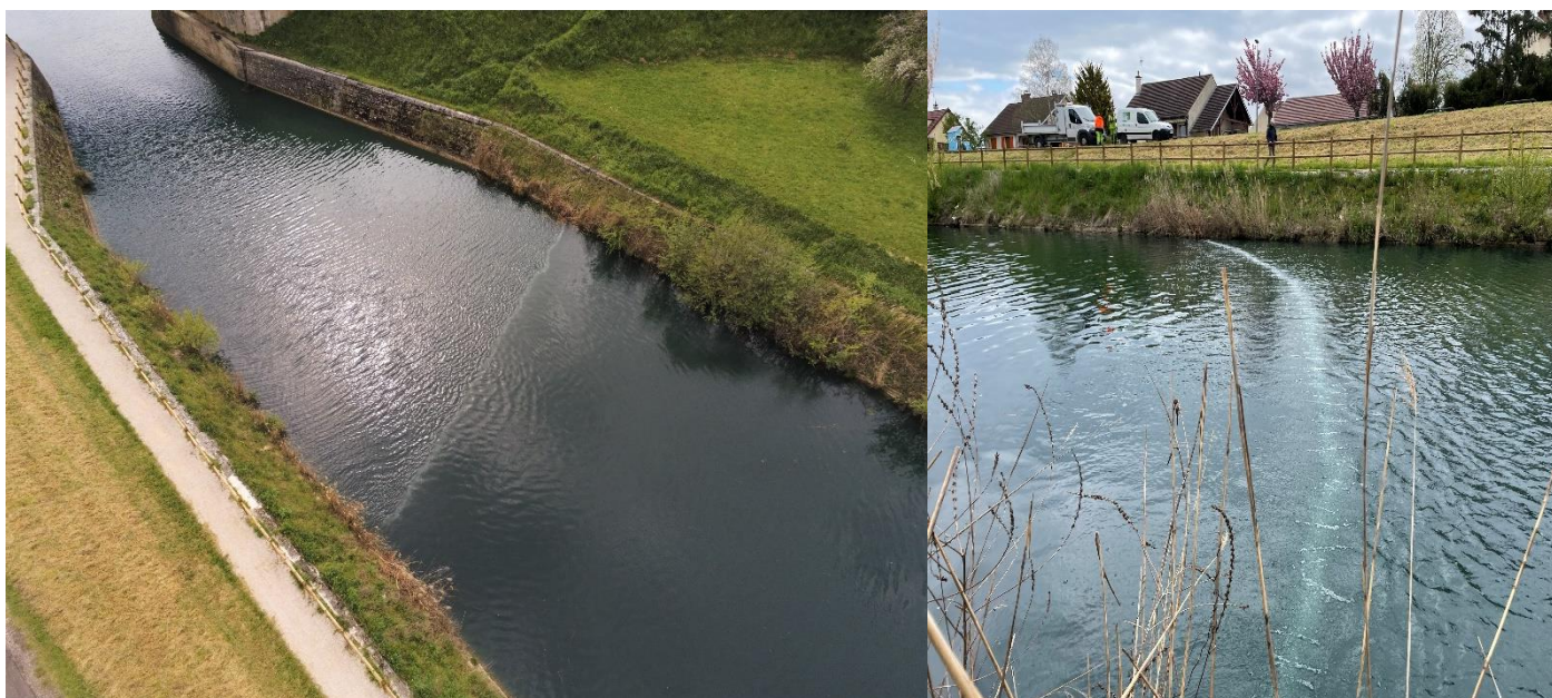
Figure 4 : Prise de vue n°1 : Contres courants générés par le rideau à bulles. Crédit Inoval
