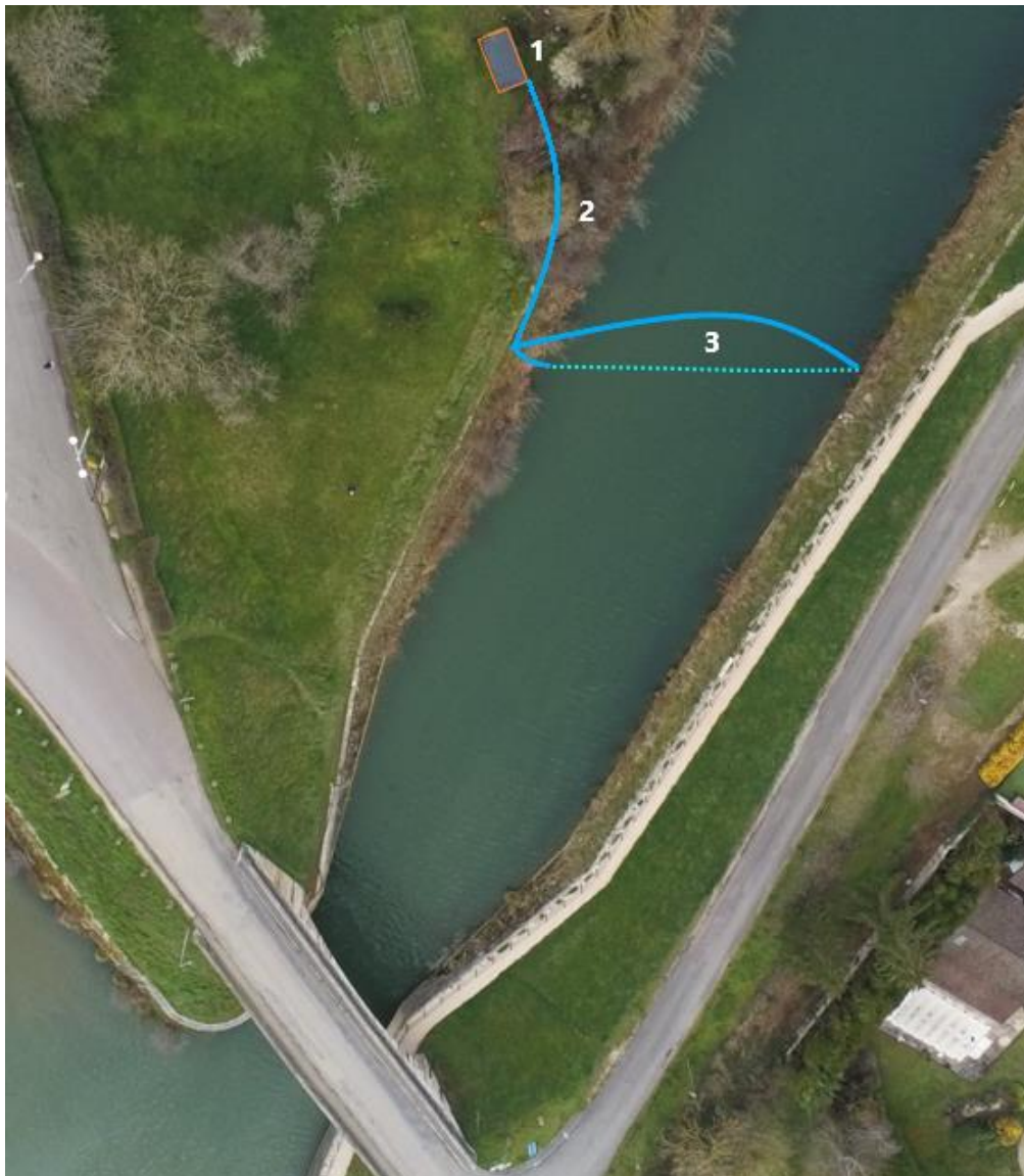
Figure 6 : Disposition des différents composants du rideau à bulles à l'entrée de la Gare d'eau. Crédit Inoval
