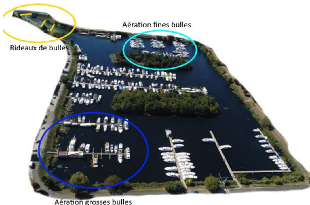
Figure 1 : Localisation en 2022 des rideaux de bulles (Rideaux à bulles BubblePro®), des aérateurs fines bulles (aération alternée BubblePro®) et des diffuseurs grosses bulles (aérateurs ZEFAIR®). Crédit Inoval
