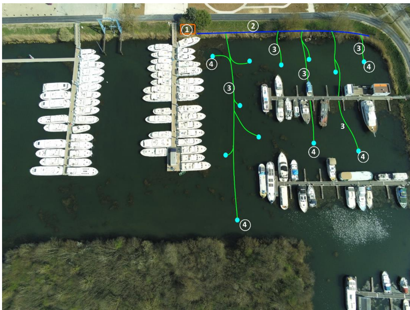
Figure 12 : Disposition des différents composants de l'aération grosses bulles avec la technologie ZEFAIR® secteur H2O Le Boat. Crédit Inoval
