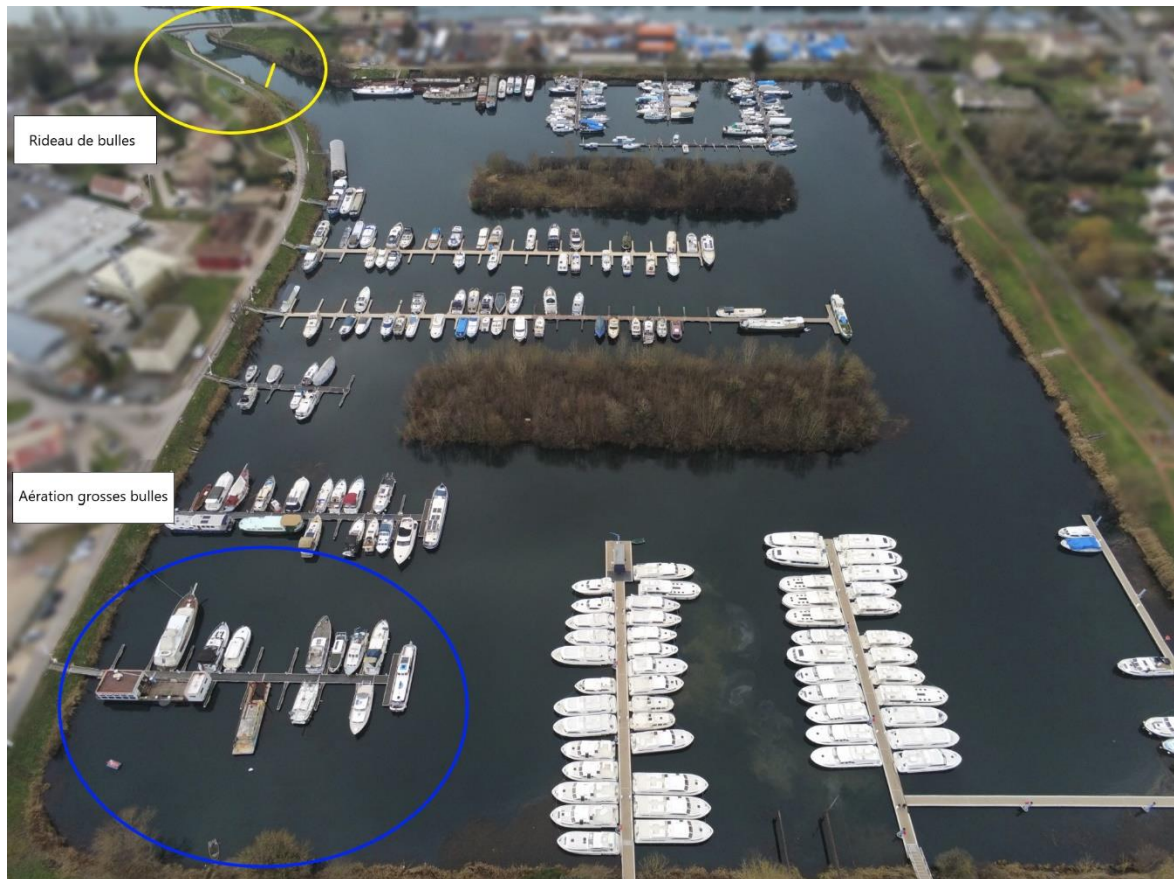
Figure 2 : Localisation en 2023 des rideaux de bulles (Rideaux à bulles BubblePro®) et des diffuseurs grosses bulles (aérateurs ZEFAIR®). Crédit Inoval
