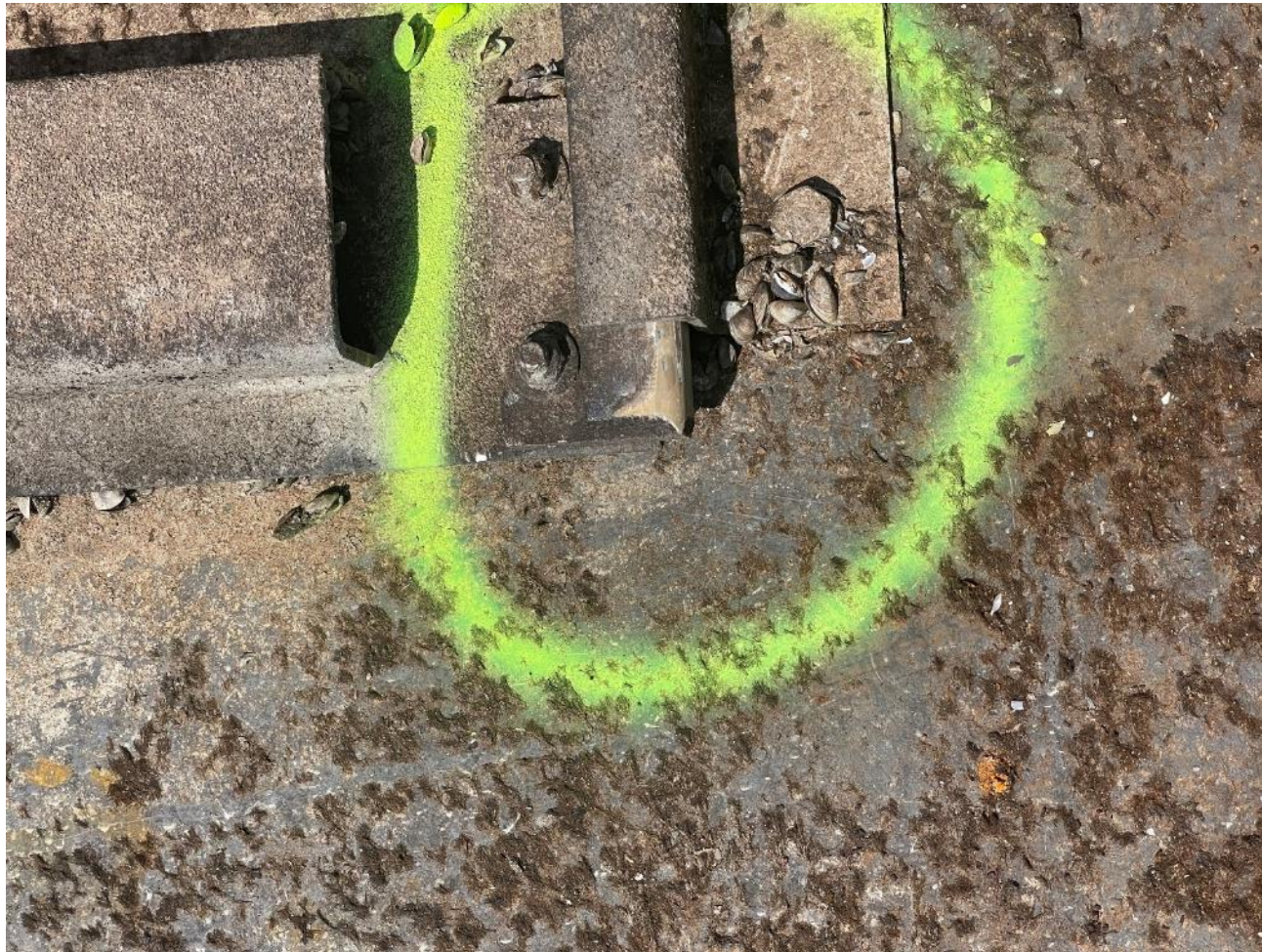
Usure et sortie des patins de guidage bronze
