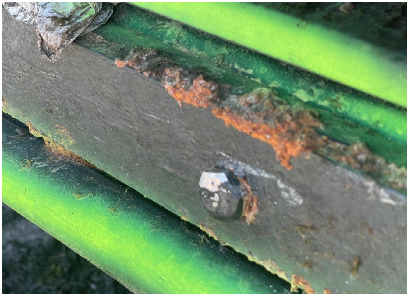
Traces de corrosions
