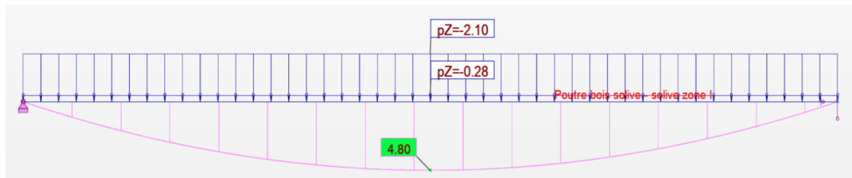
Figure 13 : diagramme du moment fléchissant à l'ELU le plus défavorable 1,35G+1,5Q
