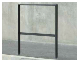
Barrière attache vélo type AERA modèle Antares (H.95 cm , L.75cm). Primaire epoxy au zinc cuit au four et thermolaquage polyester à la teinte. RAL gris au choix de l'architecte.
